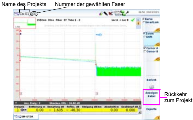
Abb. 90 Kurve der im Projekt ausgewählten Faser
