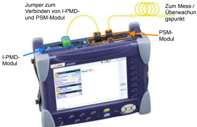
Abb. 155 Anschluss der Module
