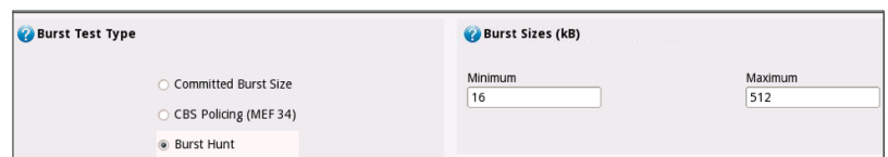
Auswahl des Burst-Suchmodus beim erweiterten RFC-2544-Test
